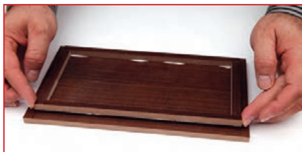
ب) قرار دادن زوار زیر در جعبه
