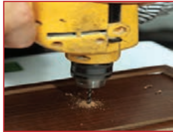
پ) سوراخ کردن در جعبه با دریل
