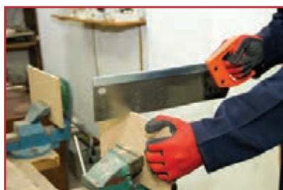
الف) بریدن قطعه‌ها با اره ظریف بر
