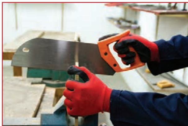
الف) برش دادن شیار
